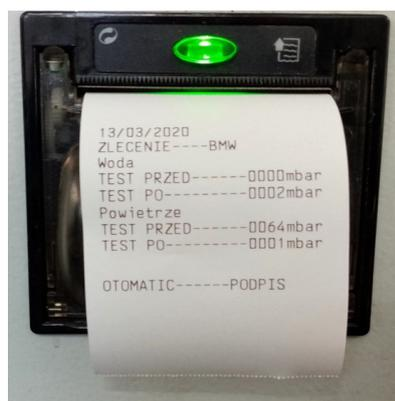
Tests mit Luft werden an einem trockenen DPF sowohl vor als auch nach der Reinigung durchgeführt. Zur Messung nach der Reinigung sollte der Nassfilter mehrere Dutzend Minuten lang getrocknet werden. Leider stellt sich manchmal heraus, dass die Tests nicht erfolgreich sind und der Reinigungsprozess wiederholt werden sollte.
